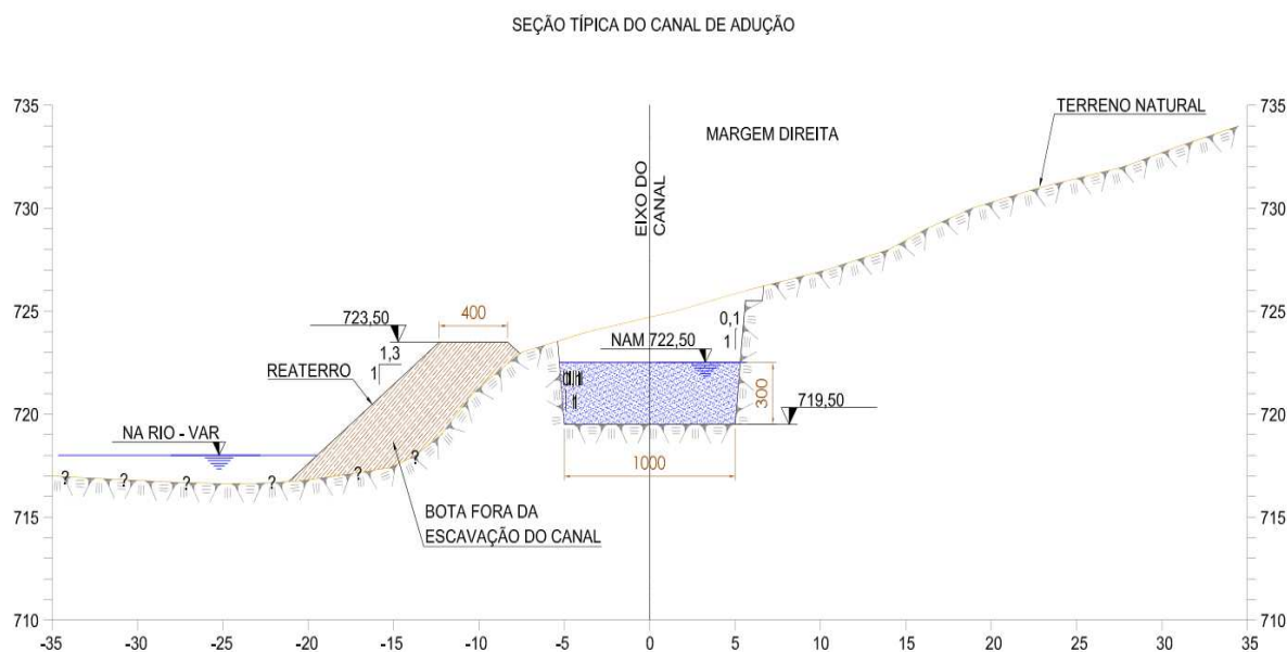
Figura 10 – Canal Adutor – Seção típica.
